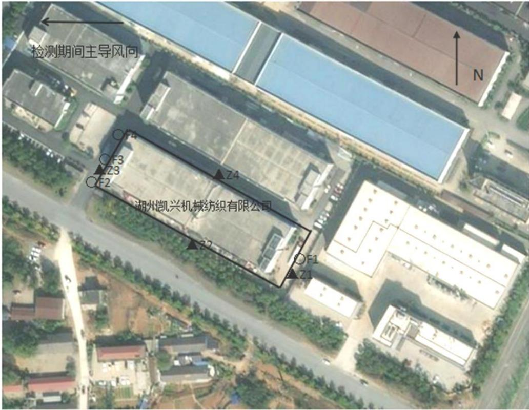
注：○-无组织废气采样点，▲-厂界噪声检测点
